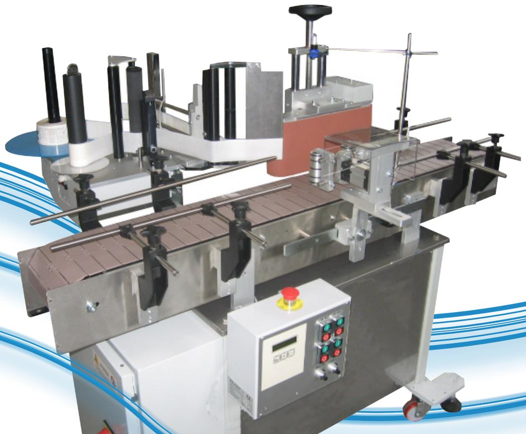
**CNC**, è un sistema di etichettatura realizzato per applicare etichette autoadesive su prodotti di forma cilindrica tramite un dispositivo a pinza pneumatica che serrando i prodotti contro il rullo di trazione conferisce al flacone la giusta rotazione per etichettare.
