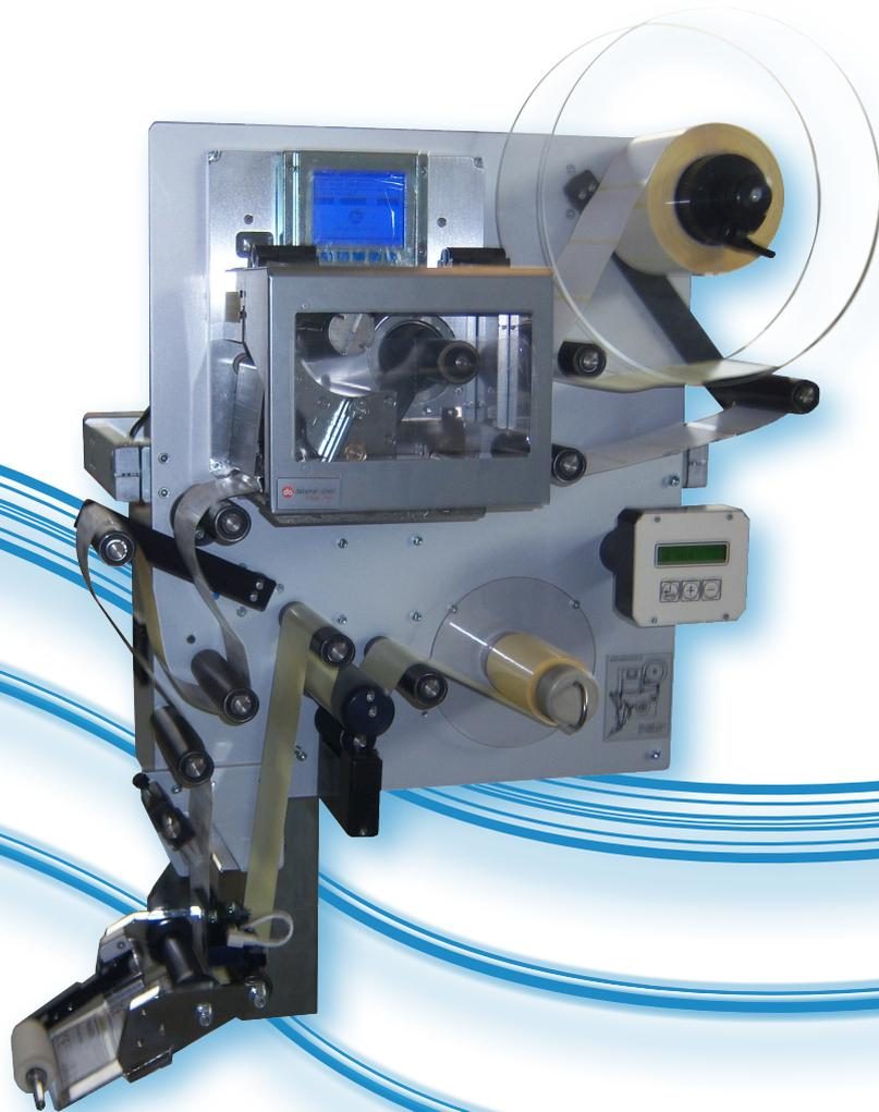
**ET-P2000 STP**, è un'etichettatrice automatica equipaggiabile con i moduli da stampa a trasferimento termico delle più importanti case costruttrici (Avery Dennison, Datamax, Cab, Sato, Zebra, ecc. ecc.) con cui è possibile stampare, lotti, scadenze, codici a barre, numerazioni progressive, grafici, etc., aprendo un'infinità di possibilità nell'identificazione e nella decorazione dei prodotti.
