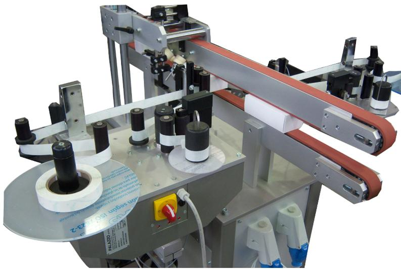
Particolare Sistema di Etichettatura che consente tramite un apposito sensore ideato e realizzato (mod. Palazzo RES-60) il rilevamento di avvenuta etichettatura del bollino di sicurezza trasparente, particolarmente adatto nel settore farmaceutico, completo di sistema di espulsione automatico, e allarme per la linea di produzione
