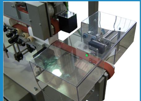
Grazie alla creazione di supporti e slitte di movimentazione, la scelta di applicazione dell'etichetta diventa semplice e veloce e facilita l'inserimento in linee produttive.
