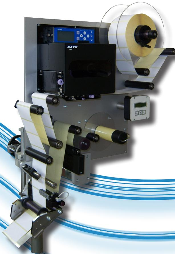
**ET-P2000 STS**, è un'etichettatrice automatica equipaggiata con il modulo da stampa a trasferimento termico LT 408 di SATO, con cui è possibile stampare, lotti, scadenze, codici a barre, numerazioni progressive, grafici, etc., aprendo un'infinità di possibilità nell'identificazione e nella decorazione dei prodotti.
